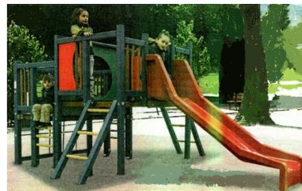
Tous ces jeux seront mis en place conformément à la réglementation, sur des zones amortissantes constituées d'une épaisseur variable (de 20 à 30 cm) de gravillon de 6 à 8 mm de grosseur.
